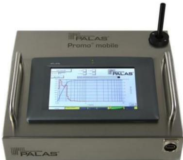
Les WELAS Digital peuvent intégrer des PC à écran tactile permettant la visualisation et le paramétrage directement des analyseurs. Ces systèmes peuvent être connectés à distance pour leur pilotage ou leur diagnostic. Les WELAS Digital équipés de PC intégré à écran tactile sont appelés PROMO. Un modèle portable du PROMO a été développé pour une application ambulatoire grâce à une alimentation sur batterie.
