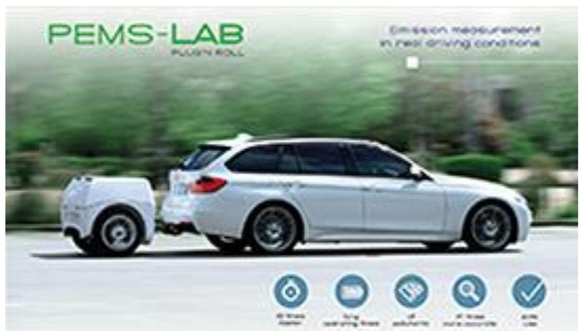
Remorque de type EP-tender avec train secondaire optionnel pour une grande facilité des manœuvres
