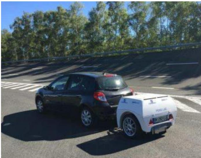
Un ingénieux système de train secondaire (optionnel) permet de soulever la remorque quand celle-ci détecte l'enclenchement de la marche arrière véhicule pour une meilleure manœuvrabilité et surtout permet de positionner cette remorque à très faible distance du véhicule évitant ainsi les effets de trainée et autre turbulence aérodynamique.
