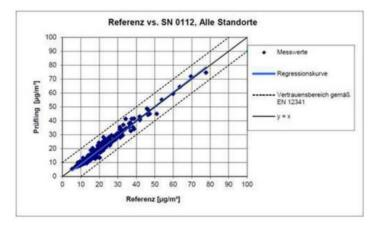
Les analyseurs FIDAS font l'objet de tests de bon fonctionnement durant 15 jours chez le fabricant, avant livraison. Cette procédure qualité est liée à la certification reçue du TÜV selon les normes : - VDI 4202-1, VDI 4203-3 - DIN EN 12341 (PM10), DIN EN 14907 (PM2.5) Les tests du TÜV et du LCSQA ont prouvé la robustesse du système, sa grande reproductibilité et la justesse de ses mesures.
