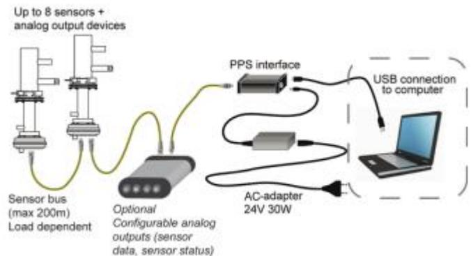
La technologie de l'analyseur PPS-M est basée sur la mesure de chargées électriques portées par les particules. Il s'agit d'une méthode non collective, limitant fortement la fréquence des opérations de nettoyage et de maintenance.
