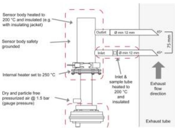
L'analyseur est équipé d'un éjecteur et doit être connecté à de l'air ou azote comprimé propre et sec. L'écoulement d'air comprimé crée une dépression au niveau de l'entrée échantillon, permettant ainsi d'aspirer l'échantillon dans l'analyseur.
