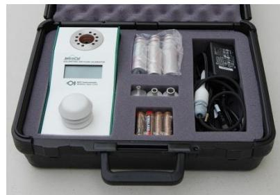
Le TetraCal peut être fourni avec une sonde de température externe supplémentaire, permettant une mesure déportée de la température (en option).
