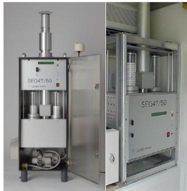
L'ensemble des têtes de prélèvement proposées (PM1, PM2,5, PM4, PM10, TSP, inlet avec dénudeur pour la mesure de HAPs) est adaptable aux 2 versions et est facilement interchangeable lui conférant un vaste champ d'applications.
