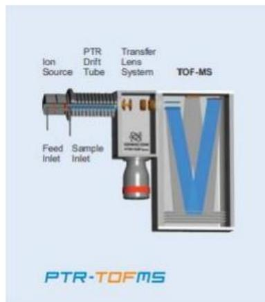
Les composés ionisés vont parcourir un trajet avec la même énergie cinétique, et seule leur masse permettra de les séparer. Les composés les plus lourds vont donc mettre plus de temps à parcourir l'analyseur que les composés légers. A chaque extraction, tout un spectre de masse est mesuré en même temps. La performance de la séparation est ce que l'on appelle la résolution massique. Avec les analyseurs à temps de vol, cette résolution en masse est suffisamment haute pour les composés isobariques.
