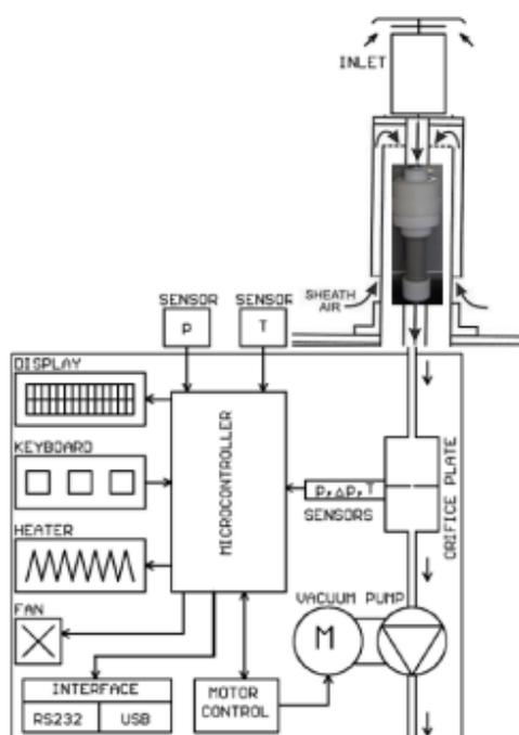
Les différentes buses des têtes de prélèvement proposées (PM1, PM2,5, PM4, PM10, TSP,) est facilement interchangeable lui conférant un vaste champ d'applications.
