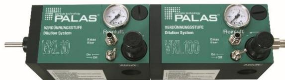
Par son design, il est possible d'utiliser différents modèles d'analyseurs en sortie de ces diluteurs, présentant des débits de 0,03 à 50 l/min. De plus, les diluteurs VKL présentent l'avantage de consommer peu d'air comprimé pour assurer la dilution.
